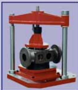
Particolare valvola lavorata con centro Trevisan
