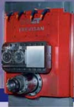
Particolare testa Trevisan con dispositivo di tornitura
