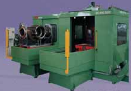
DS 600/200C Diametro tornibile 900 mm
