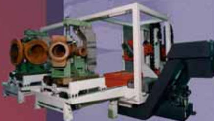
DS 900/300C Diametro tornibile 1500 mm
