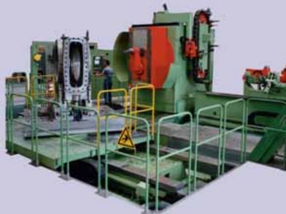
DS 2000/1000C Diametro tornibile 3000 mm
